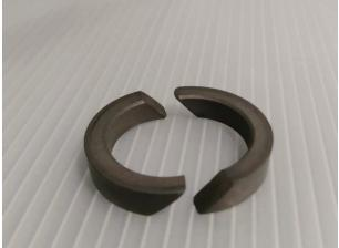
FIGURE 12 - SLIDING RING CUTTING
